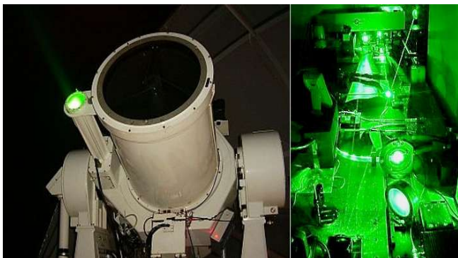
Vysílací a přijímací dalekohled a laserové srdce celého přístroje.
